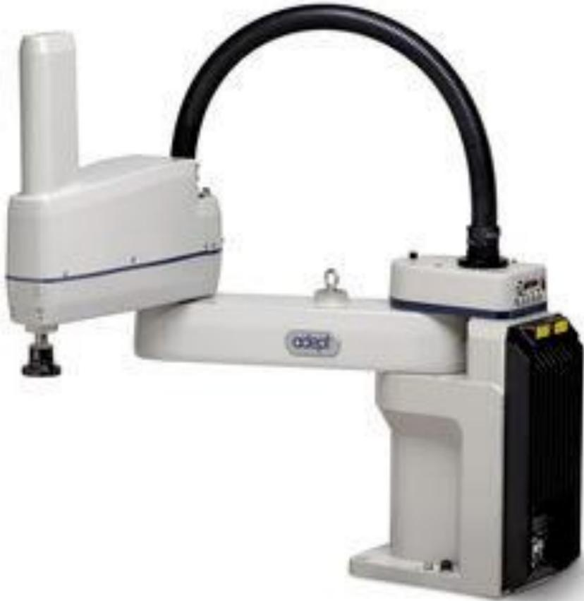
Robot SCARA della marca OMRON
